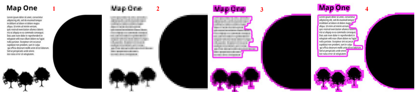
Obrázok 14: Schematické znázornenie krokov (1–4) optimalizovaného výberu elementov v rámci prípravy pre zber dát. (pozn. ružová oblasť ilustratívne znázorňuje priebeh vytýčenia obrazu – oblasť výberu bude definovaná vnútorným rámom)
